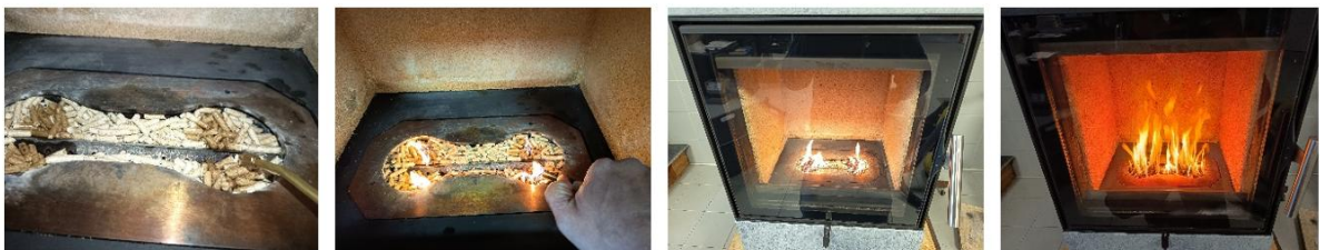
Abbildung 10: Richtiges Anzünden der Pellets
