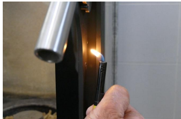
Abbildung 1: Unzureichender Rauchgaszug (links), auszureichender Rauchgaszug (rechts)
