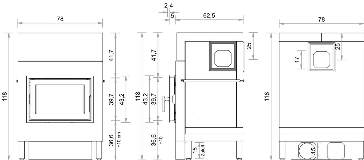
Abgang oben, links, rechts und hinten möglich (hinten horizontal verschiebbar, bei Bestellung bitte angeben).
