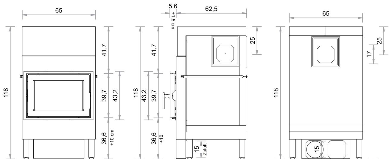
Abgang oben, links, rechts und hinten möglich (hinten horizontal verschiebbar, bei Bestellung bitte angeben).
