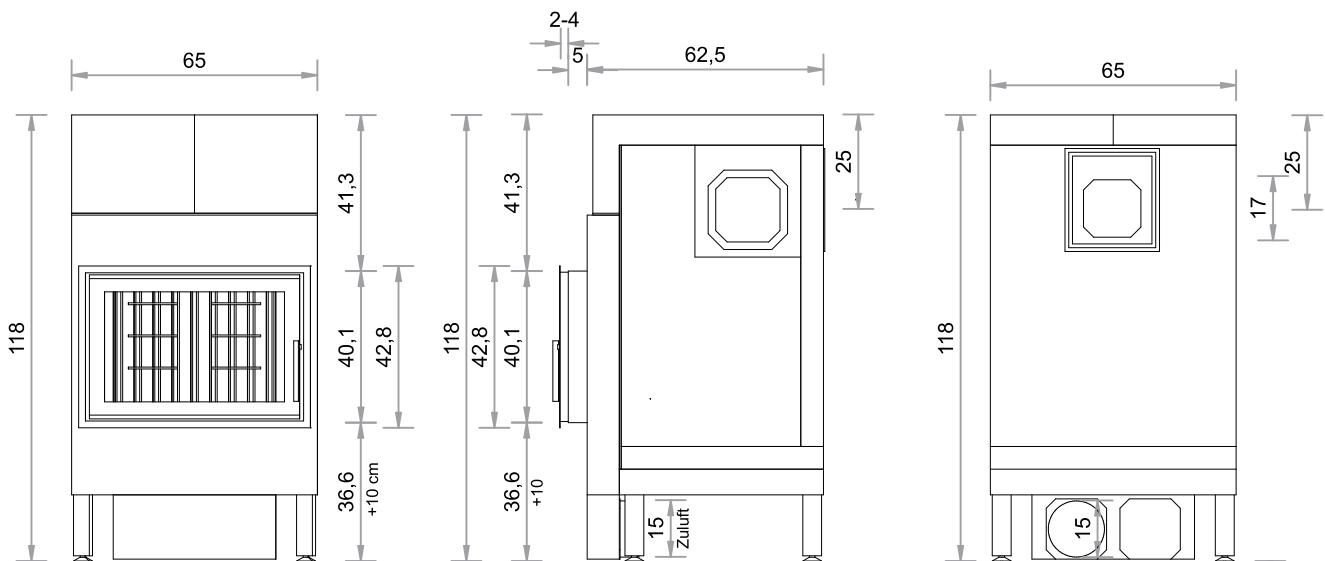
Abgang oben, links, rechts und hinten möglich (hinten horizontal verschiebbar, bei Bestellung bitte angeben).
