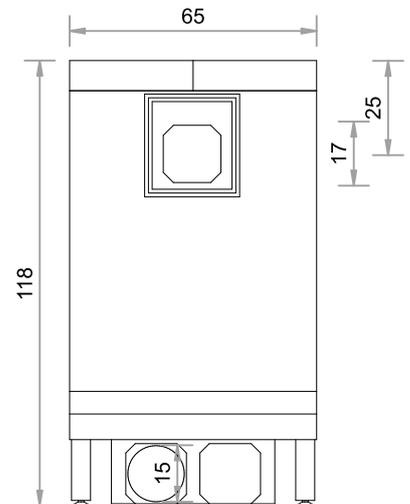
Abgang oben, links, rechts und hinten möglich (hinten horizontal verschiebbar, bei Bestellung bitte angeben).
