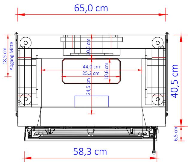
Gusstüre - Anschlag links/rechts wechselbar
