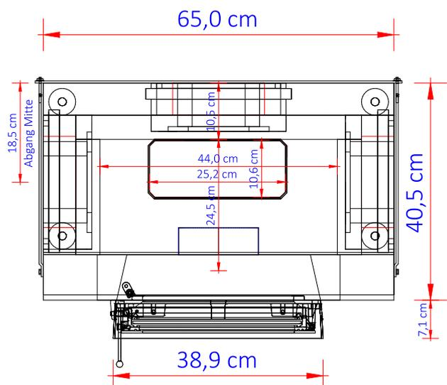
Gusstüre - Anschlag links/rechts wechselbar
