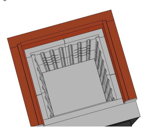
21. Auf der richtigen Höhe setzen Sie die Bolzen ( rot gekennzeichet auf dem Bild).
