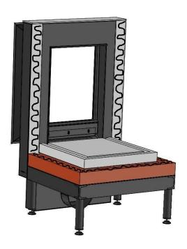
4. Die Außenseiten aufstellen und fest an die Dichtung drücken. Danach tragen Sie Silikon auf die Außenseiten (siehe Bild), um den Rückenteil zu befestigen.
