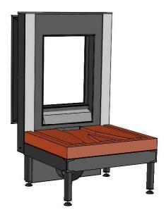
3. Den Innenboden mittig legen und fest an die Dichtung drücken. Silikon, wie auf dem Bild gezeigt, auftragen. Es soll die Seiten mit der Dichtung der Frontseite sowie des Bodens zusammenkleben.
